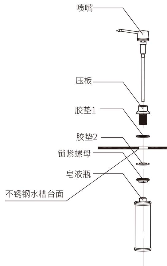
按图所示将压板、胶垫1、胶垫2、锁紧螺母、皂液瓶进行安装,注入清洗剂,再装入喷嘴。
