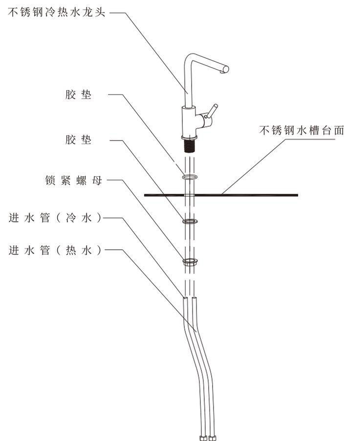
按图所示,依次将不锈钢冷热水龙头、胶垫1、胶垫2、锁紧螺母、进水管(冷水)、进水管(热水)进行安装。注意拧紧,防止漏水。
